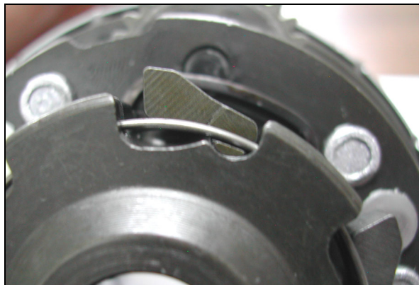
Figura 9. Detall del cadell d'un mecanisme d'escapament.
