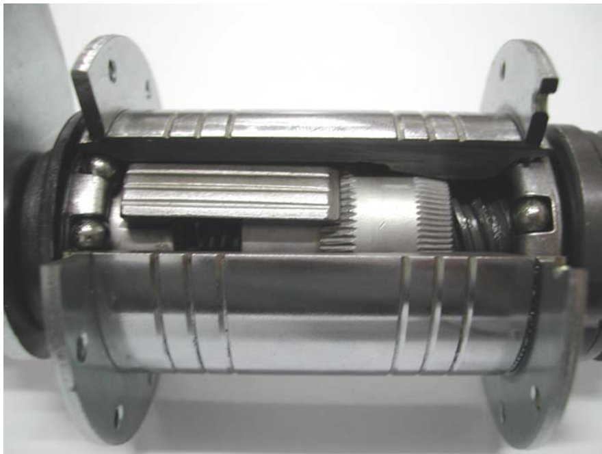
Figura 10. Boixa amb fre de contrapedal seccionat
